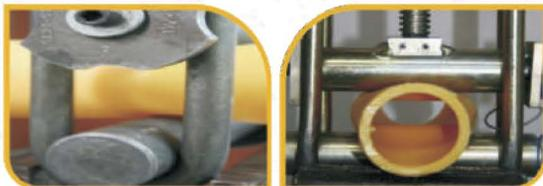
Se coloca la herramienta sobre el centro del tubo y perpendicular a éste. Esto permitirá que el tubo se aplaste libremente, sin que se atasque contra el armazón de la herramienta o los rebordes. La colocación de la herramienta debe ser mínimo a cinco diámetros del tubo o 30 cm mínimo entre el punto de la termofusión del tubo con tubo; tubo con accesorio u otro punto de aplastamiento.
