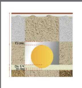
El tubo debe apoyarse uniformemente en toda su longitud sobre material estable. No debe estar apoyado sobre bloques espaciados en forma intermitente en ninguna parte de la zanja.
