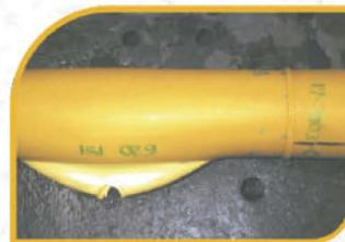
Recomendado para todo tipo de procedimiento en termofusión. Se somete la termofusión a presión hidráulica interna hasta que se produzca la falla en un tiempo corto (60 a 70 segundos) sin que se presente desprendimiento o fugas por el sitio de la termofusión.
