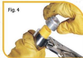
**Fig. 4** Ubicar el calibrador de profundidad...
