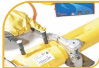
En el display aparece ahora la tensión de soldadura así como el tiempo de soldadura teórico y real.
